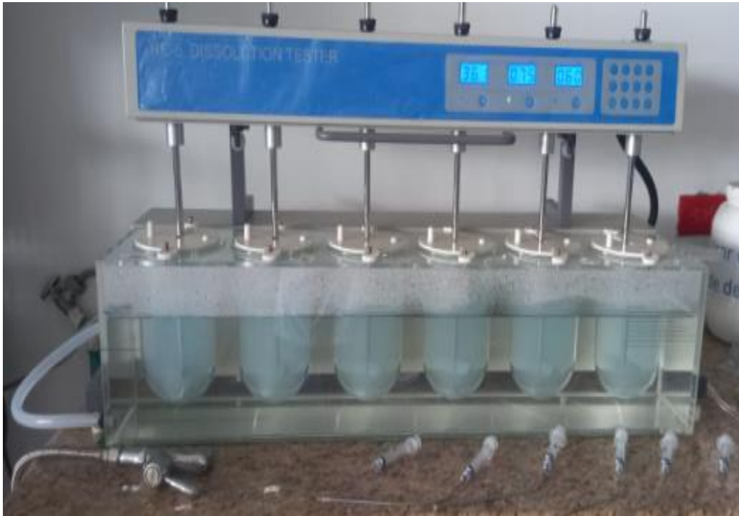
Figura 9. Disolutor a los 10 min de haber iniciado con las cápsulas de itraconazol
