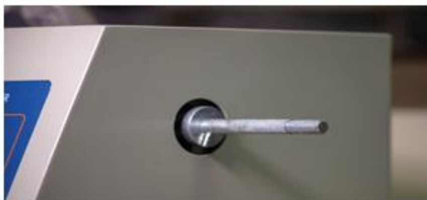
Figura 3. Ubicación de los ejes de nivel del equipo
