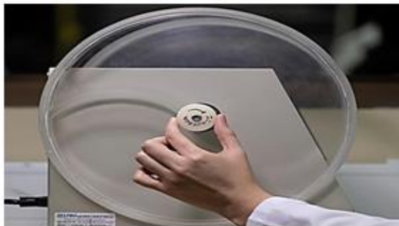
Figura 2. Ubicación de los pernos que sostienen los tambores
