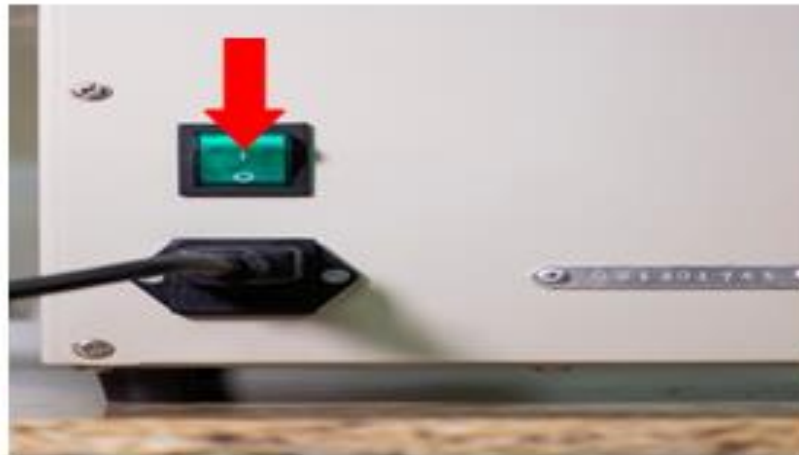
Figura 1. Ubicación del interruptor del equipo
