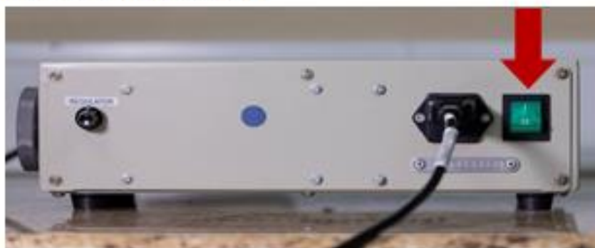
Figura 1. Ubicación del interruptor del equipo
