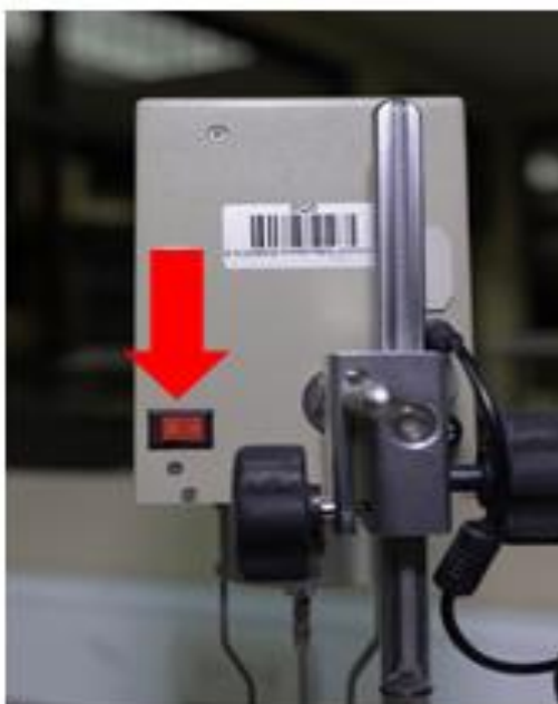
Figura 4. Ubicación del interruptor del equipo
