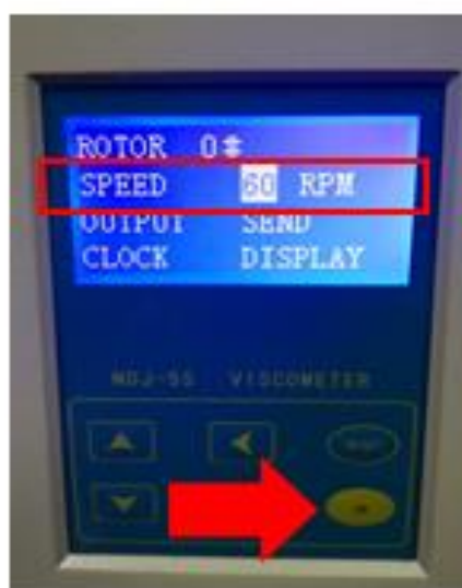
Figura 10. Ubicación del botón OK en el equipo
