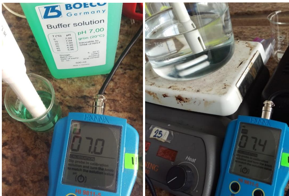
Figura 21. Calibración de pH Metro
