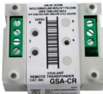
Figura 16. Módulo de relé
