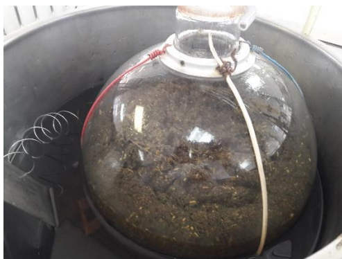
Ilustración 22. Colocación de balón en baño de glicerina
