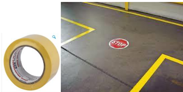
Figura 58. Demarcación de pasillos, carriles y celdas de trabajo
