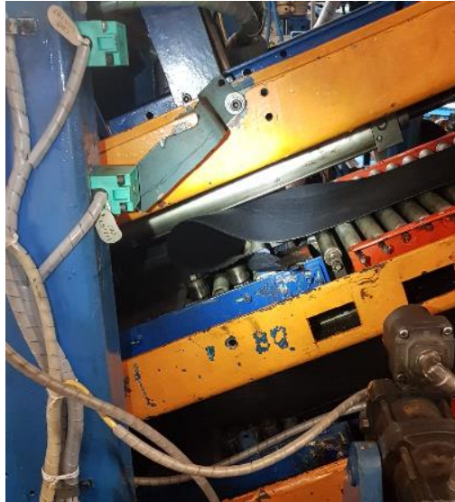
Figura 62 Capa estabilizadora enredada en los rodillos de la máquina KB-13
