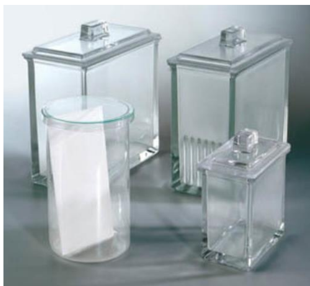
Figura 6. Ejemplos de cámaras reveladoras para cromatografía de capa fina.
