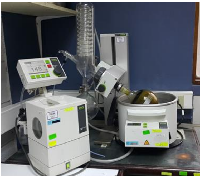
Figura 14. Equipo de rotavapor utilizado en las pruebas de concentración de los extractos de Senna Reticulata (Saragundi)
