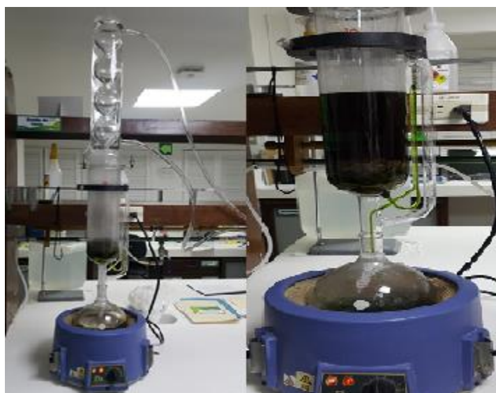
Figura 12. Método de extracción de la Senna reticulata por el método de reflujo cerrado (soxhlet)
