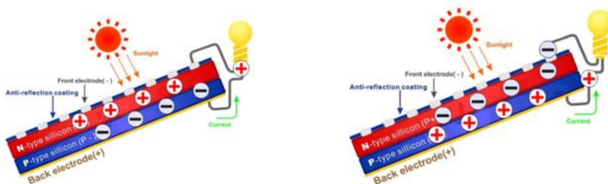
Figura 10. Semiconductor de la unión P-N
