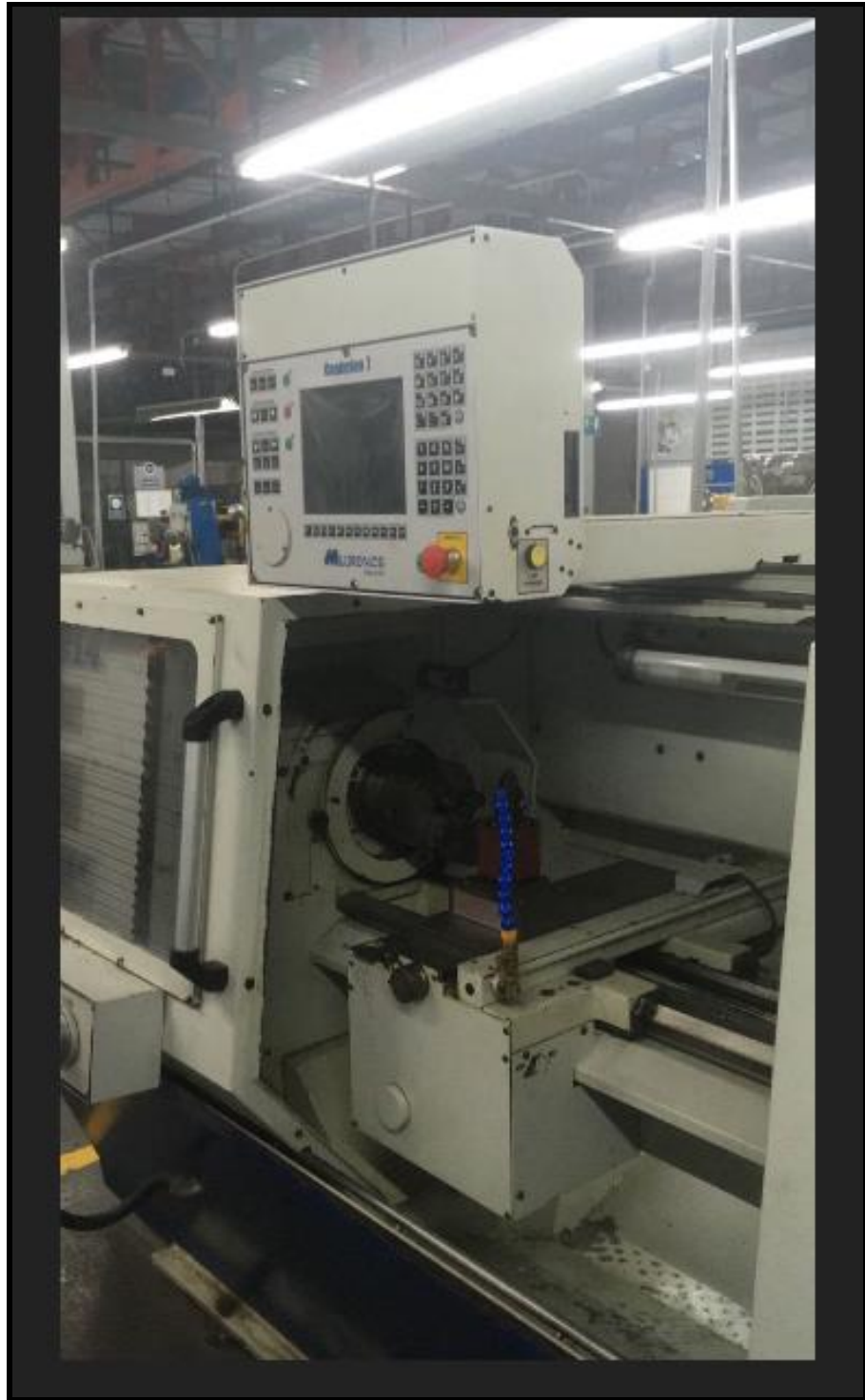
Figura 2:Torno con Centro Numérico Computarizado (CNC)
