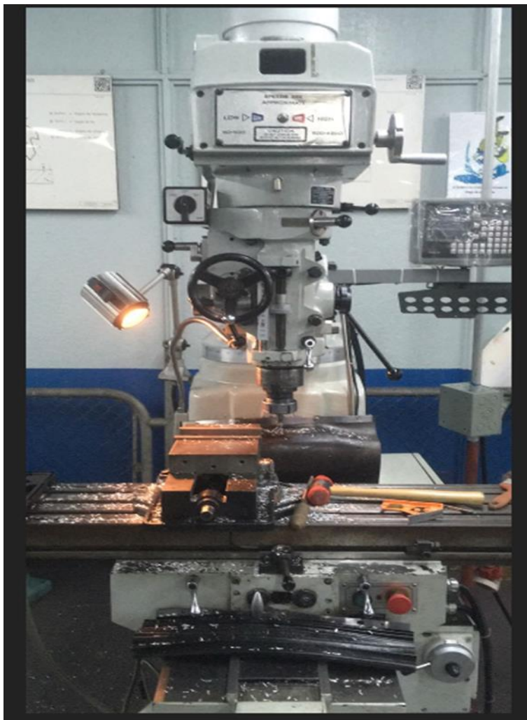
Figura 3: Fresadora Convencional y sistematizada con CNC
