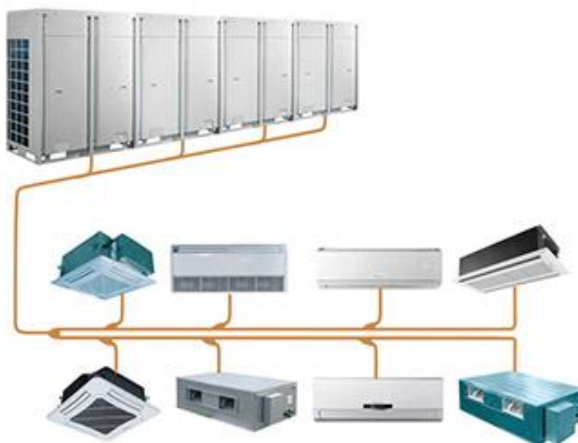
Figura 9 Aire acondicionado tipo volumen variable de refrigerante (VRV)
