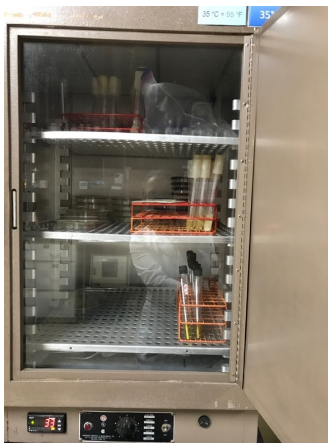
Figura 33. Incubadora para el Cultivo de Bacterias
