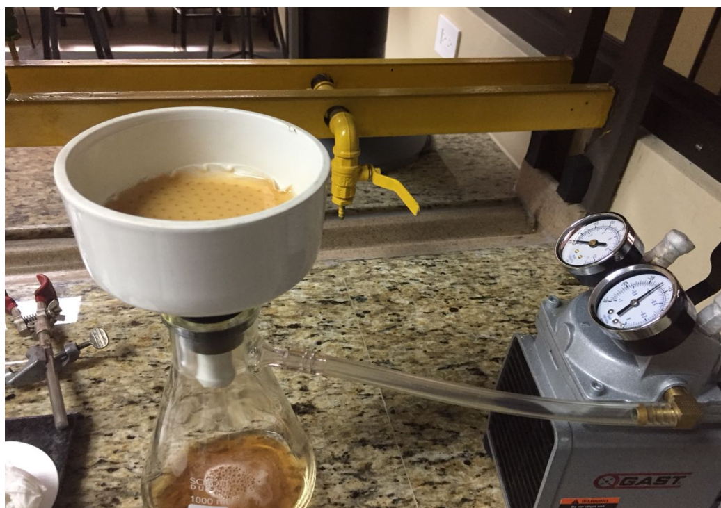
Figura 26. Filtración al Vacío de Extracto Metanólico de Bixa orellana
