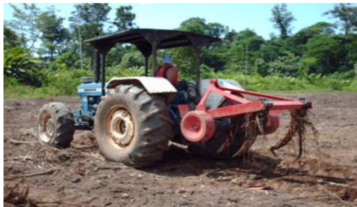
Figura 4: Proceso de subsolado para retirar capas duras
