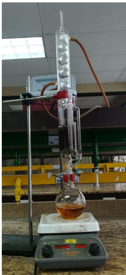
Figura 23. Equipo de Soxhlet Empleado en la Obtención del Extracto
