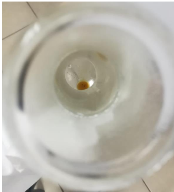
Figura 35. Extracto Obtenido Mediante Arrastre por Vapor
