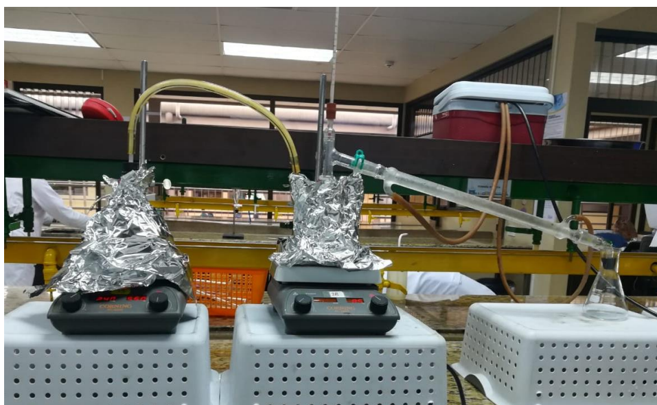
Figura 25. Equipo de Arrastre por Vapor
