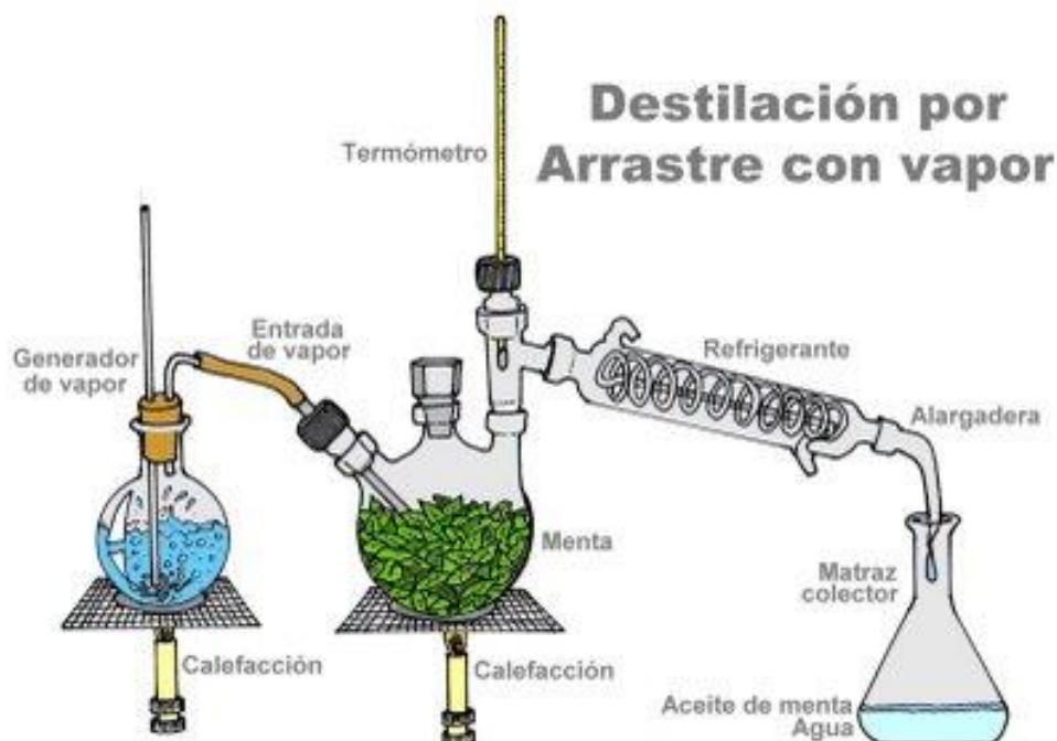
Figura 7. Equipo de Destilación por Arrastre de Vapor
