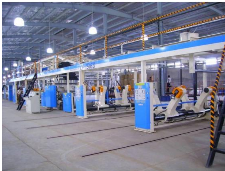
Figura 1 Mill Roll Stand, modelo MR80.
