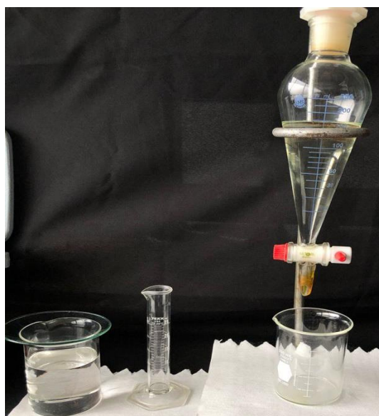
Figura 40 Extracto acuoso y cloroformo en un embudo separador
