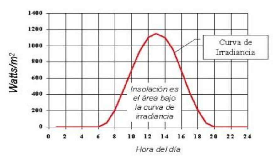
Figura 20. Curva de irradiación solar.
