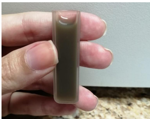
Figura 37. Muestra de nanopartículas de plata a partir del extracto de Nephelium lappaceum en la cubeta de cuarzo para su lectura en el espectroscopio UV-visible.
