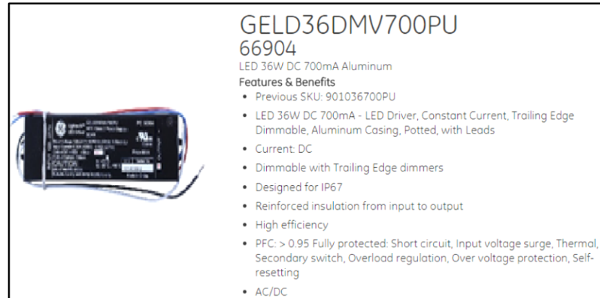
Figura 23: características del balastro D-GELD36DMV70 GE66904
