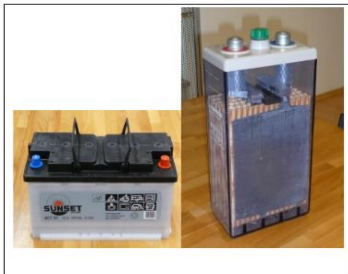
Ilustración 21. . Baterías de plomo-ácido. Izquierda: una batería sellada de placa plana de 100Ah Sunset solar de 12v diseñada para sistemas pequeños. Derecha: Una pila plomo ácido Hoppercke de ciclo profundo.
