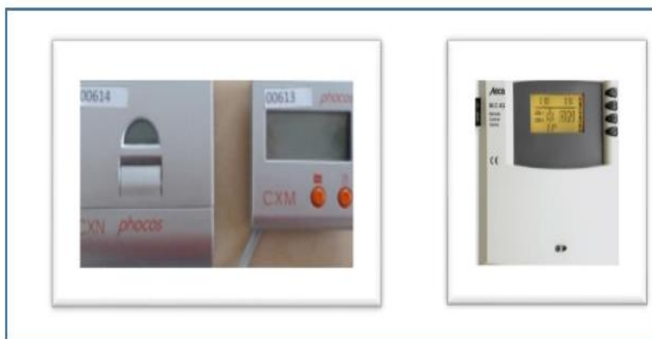
Ilustración 39. Controlador de carga Phocos. Derecha: Monitor inversor Steca.
