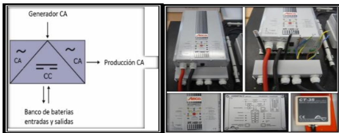
Ilustración 15. Izquierda: Símbolo de un inversor-cargador. Derecha: Inversor-cargador Compact C-1600-12 de 1600w de Steca
