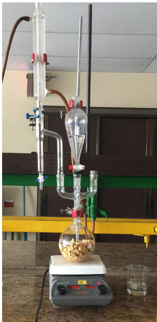
Figura 15. Equipo de hidrodestilación.
