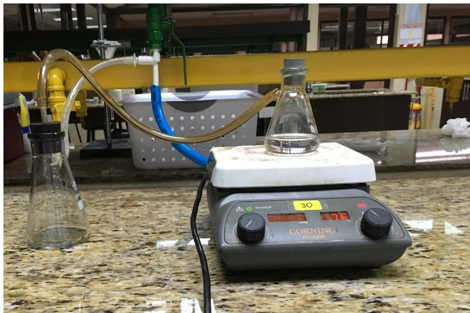
Figura 21. Equipo de arrastre al vacío.
