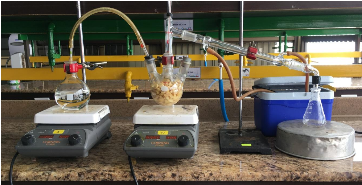
Figura 19. Equipo de destilación de arrastre por vapor.
