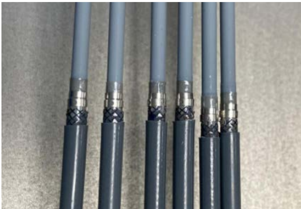
Figura 4 Unidad con componentes internos (trenzado, anillo plástico, plástico PTFE, anillo metálico y anillo de titanio)
