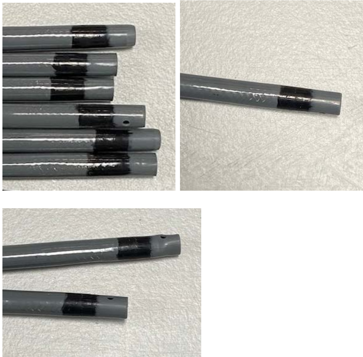
Figuras 15 Unidades con alambrado expuesto.
