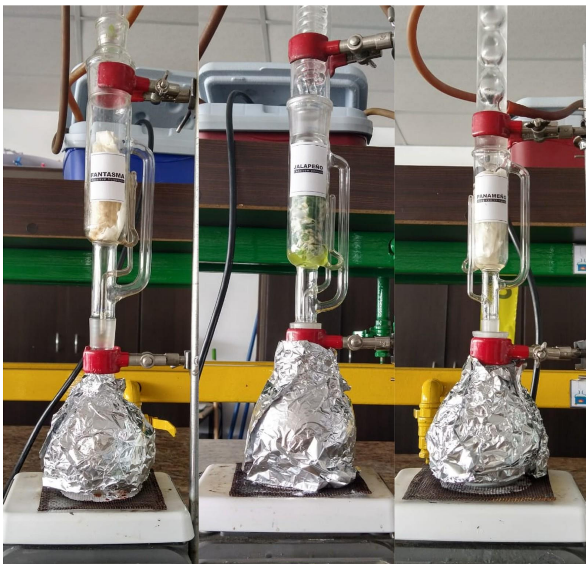
Figura 25 Equipo Soxhlet - Extracción con Acetona
