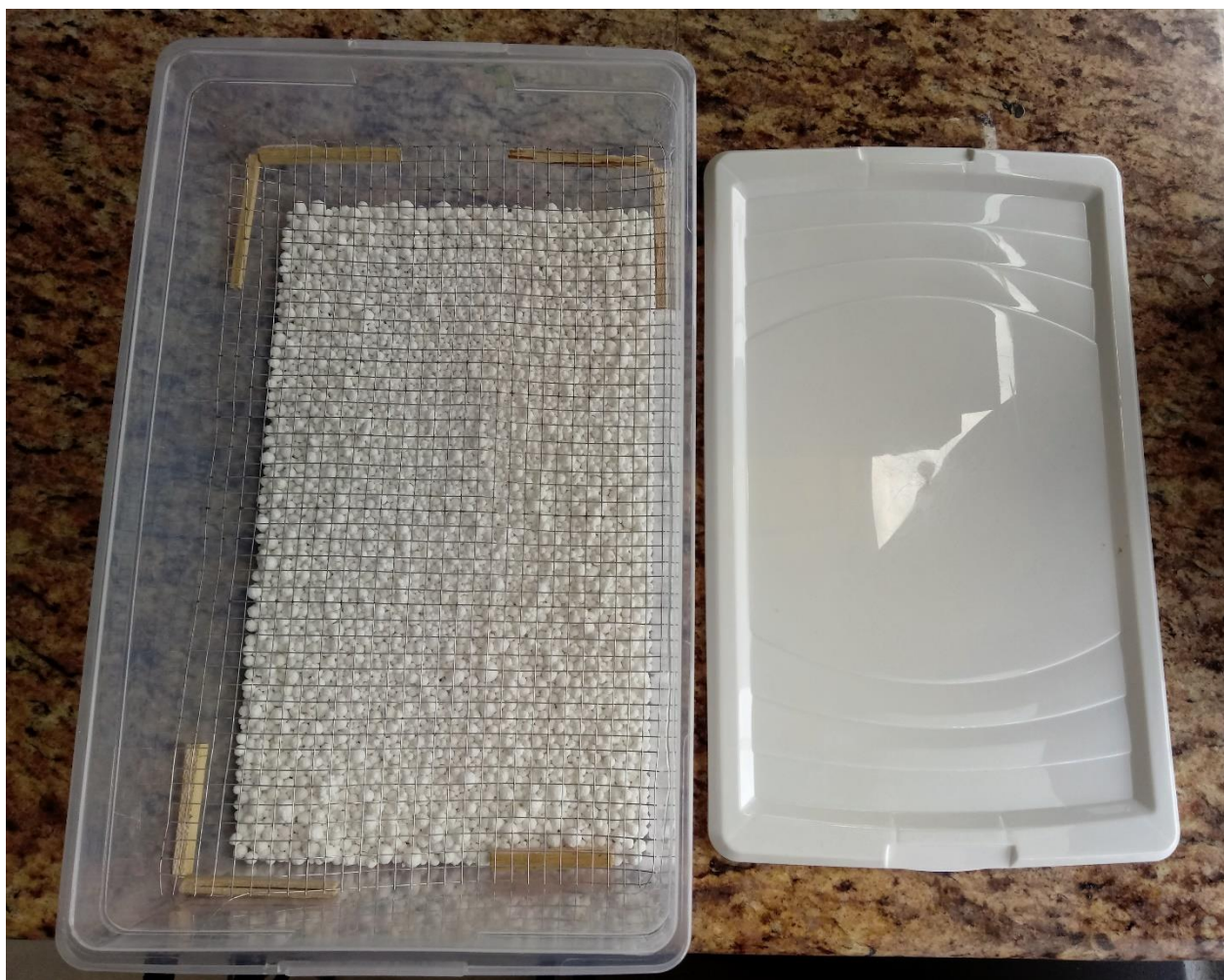
Figura 8 Dispositivo de desecación
