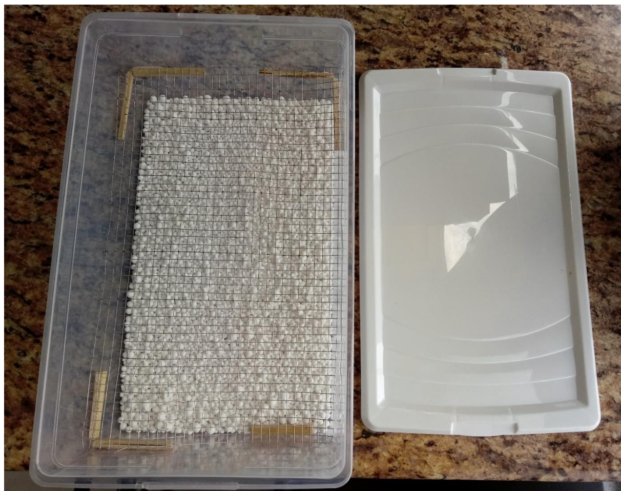
Figura 19 Dispositivo desecador con cloruro de calcio como desecante
