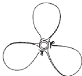
Figura 16. Agitador tipo hélice de tres aspas.
