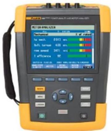
Figura 36. Analizador de energía FLUKE 438-II.
