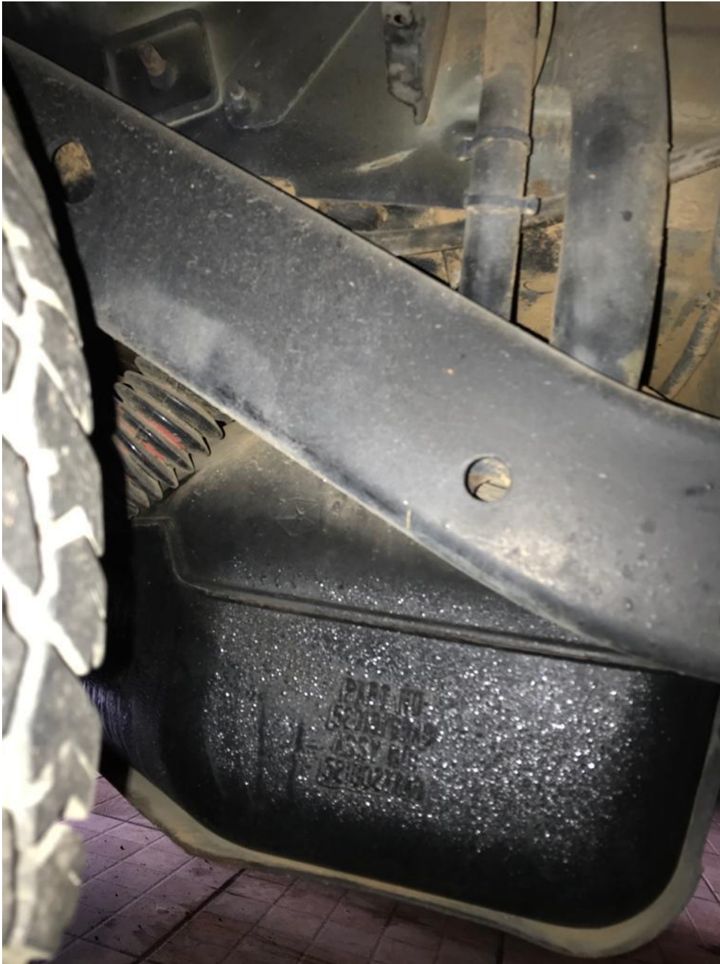
Imagen 2. Tanque de combustible visto del lado del conductor
