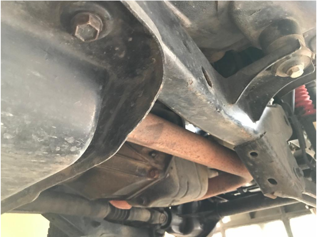
Imagen 8. Sistema de escape. Tubería entre motor y catalizador
