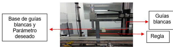
Figura 12: Ajustar las guías blancas de las agujas
