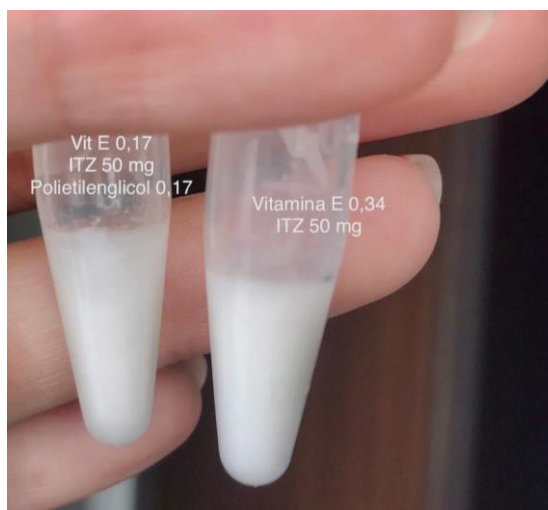
Figura 7. Prueba de solubilidad con medio oleoso, a partir del uso de Vitamina E 70% concentrado
