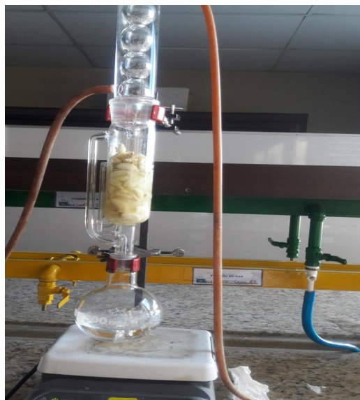
Figura 32. Equipo de Soxhlet.
