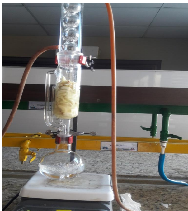
Figura 23. Extracción en Soxhlet.
