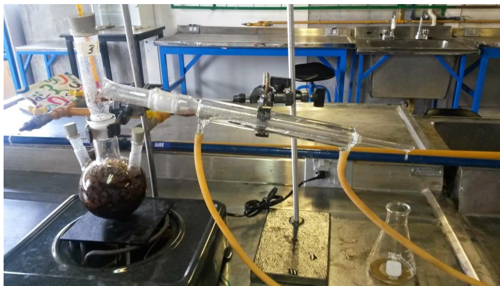
Figura 21. Equipo de hidrodestilación.
