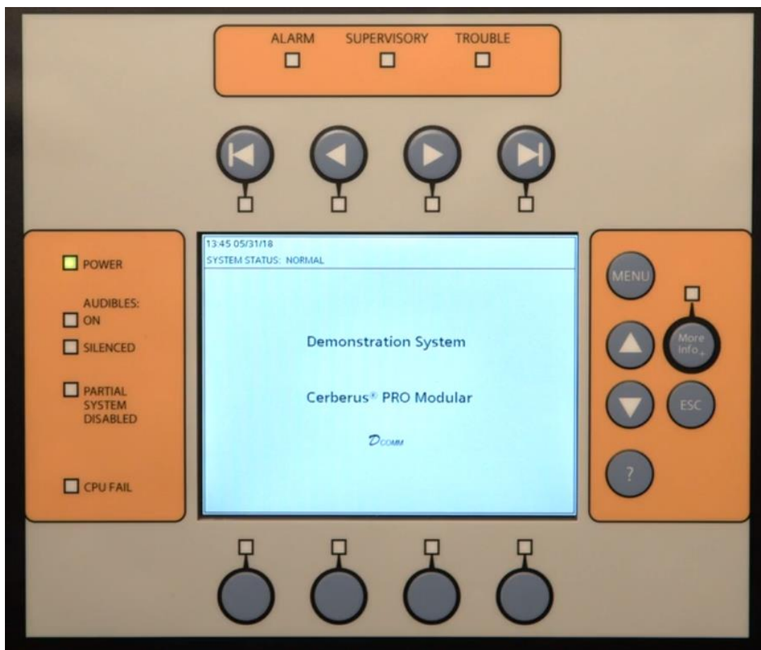
Figura 57: Panel de detección de incendio panel normal
