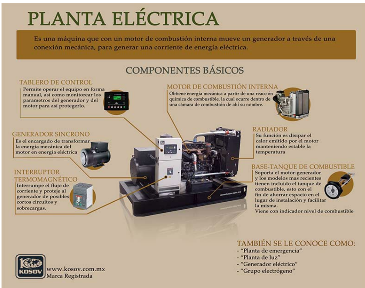
Ilustración 2. Componentes básicos del grupo electrógeno
