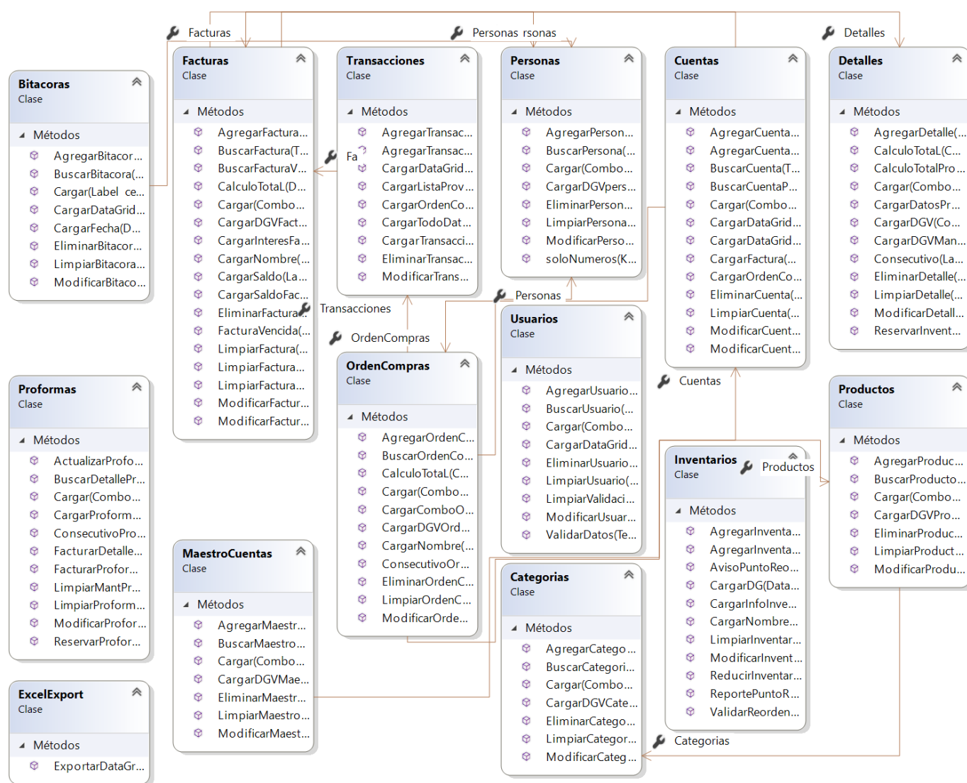
Imagen 60. Diagrama de clases del prototipo funcional
