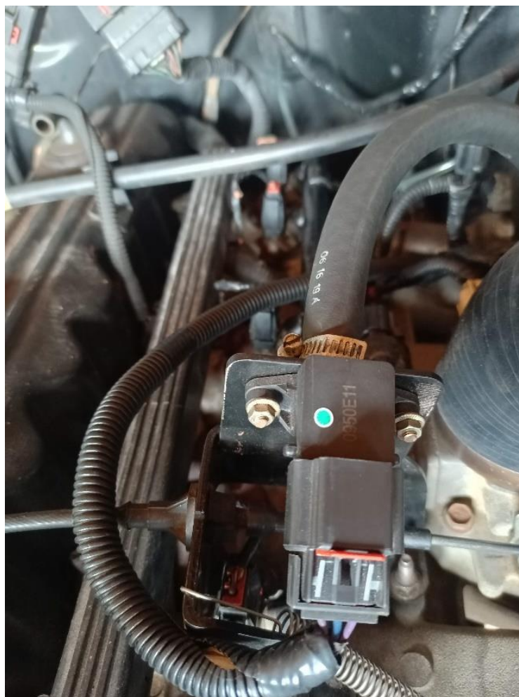
Imagen 70. Fotografía del sensor MAP nuevo de 2 Bares.
