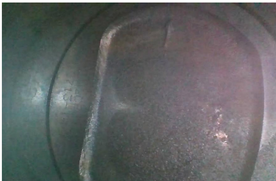
Imagen 72. Fotografía endoscópica de la corona del pistón dentro del cilindro luego de 2000 kilómetros con el turbocompresor.
