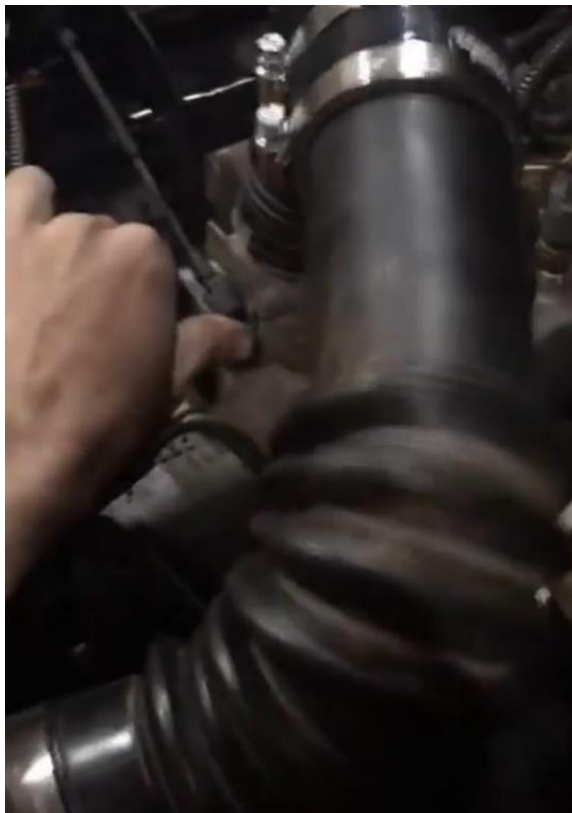
Imagen 62. Primer codo instalado expandido por la presión positiva.
