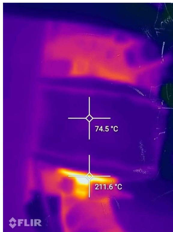
Imagen 59 Fotografía termográfica comparación entre acople de la turbina del turbocompresor y cobertor de turbina de fibra de vidrio.
