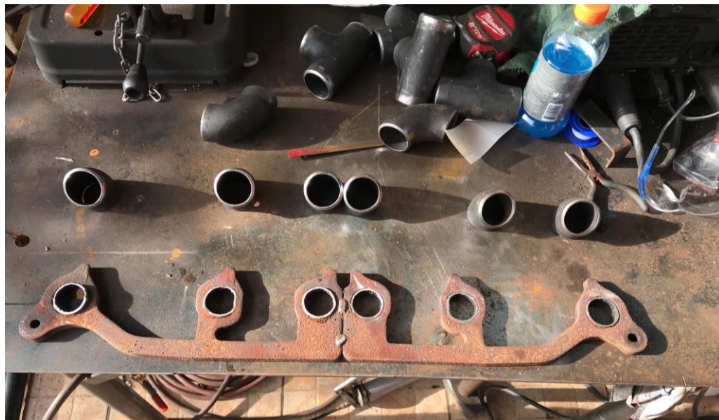
Imagen 33. Inicio de la construcción del colector de escape
