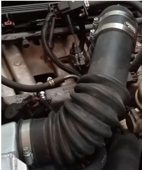
Imagen 62. Primer codo instalado expandido por la presión positiva.
