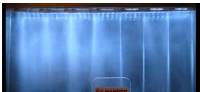
Imagen 17. Comparación de la aspersion entre un inyector de 4 orificios (4 izquierdos) y de un orificio (los 4 siguientes a la derecha)
