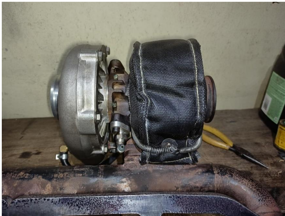
Imagen 57. Cobertor de fibra de vidrio instalado
