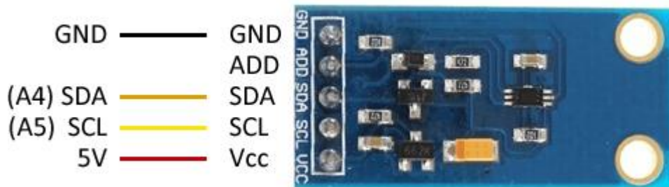
Figura 96: conexión a Arduino de luxómetro
