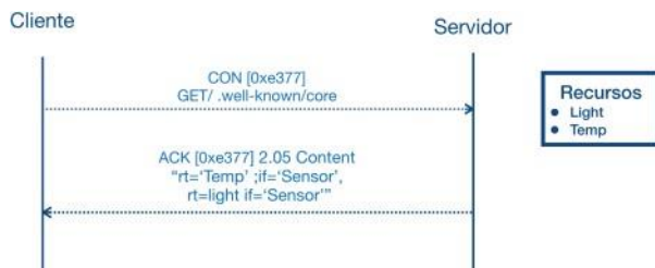
Figura 61: comunicación de cliente/servidor
