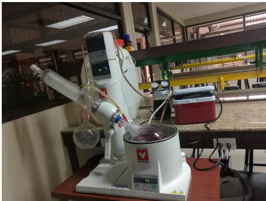
Figura N° 24. Método de destilación del extracto en el rotavapor
