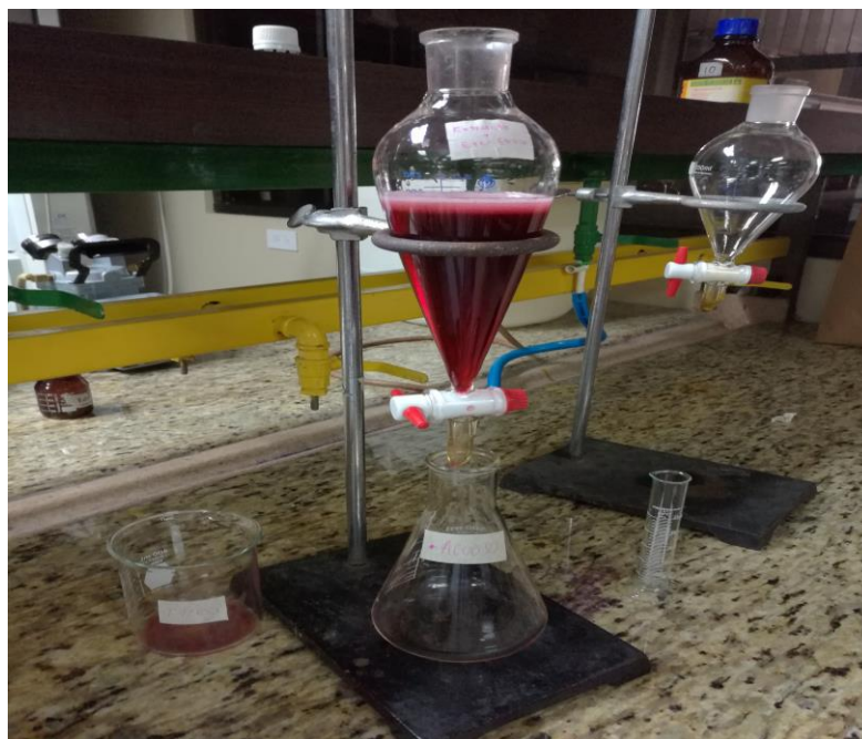
Figura N° 26. Extracción líquido-líquido en embudo separador del extracto acuoso con éter etílico
