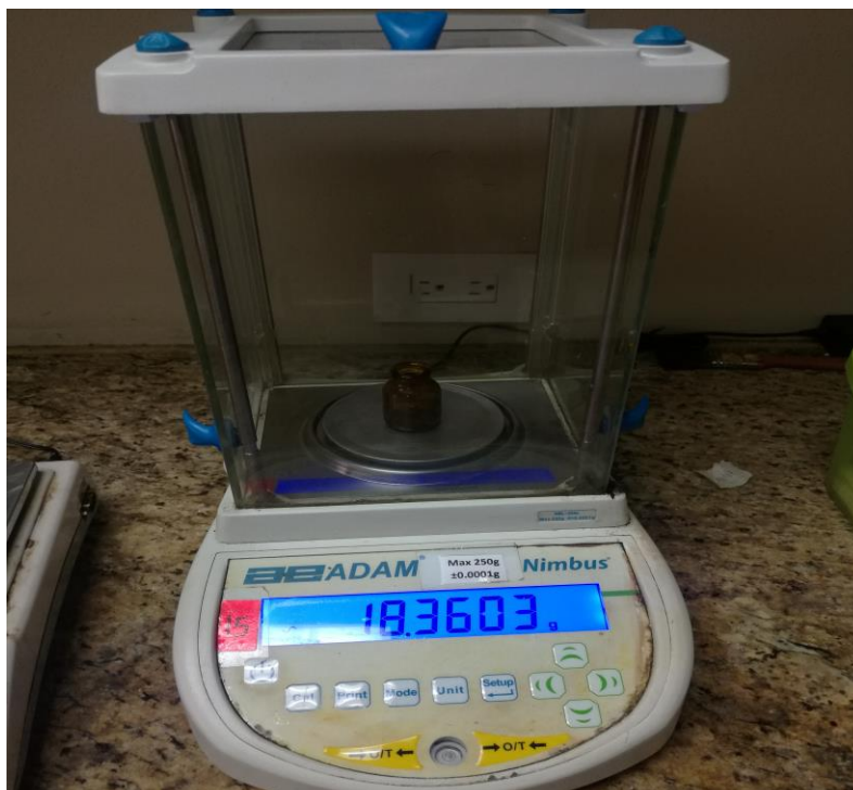
Figura N° 29. Determinación de la masa de extracto acuoso contenido en un vial de vidrio
