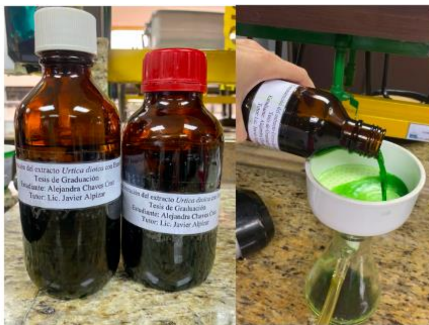
Figura 18. Recipiente con el material en maceración y equipo para filtración al vacío del material macerado de la planta Urtica dioica (Ortiga)
