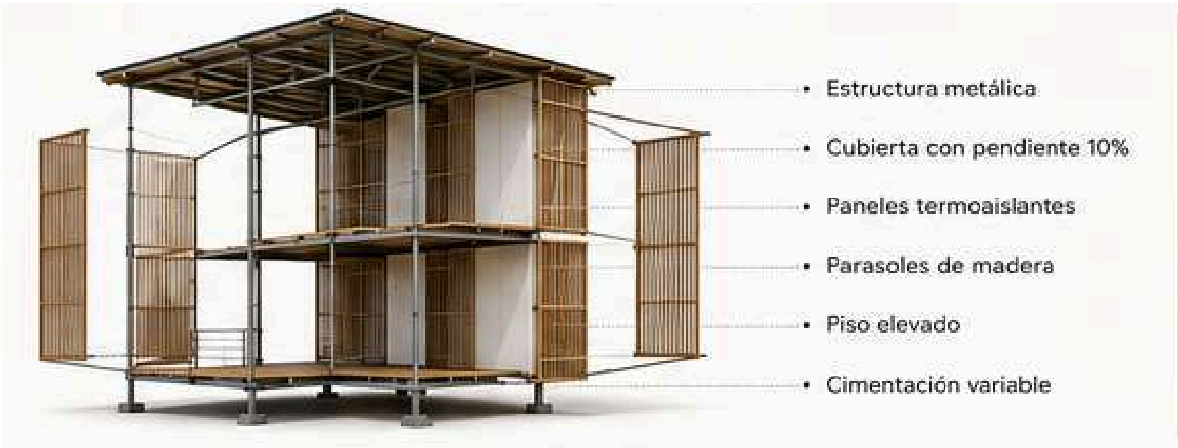
ISOMÉTRICO SISTEMA CONSTRUCTIVO BASE
