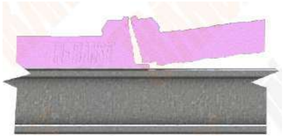
Figura C03- 29 Ensamblaje del Panel PIR Techo Fuente (In-Transit S.R.L Costa Rica)
