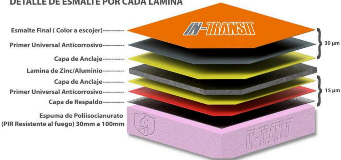
Figura C03- 28 Detalle de esmalte de techo aislante PIR Fuente (In-Transit S.R.L Costa Rica)
