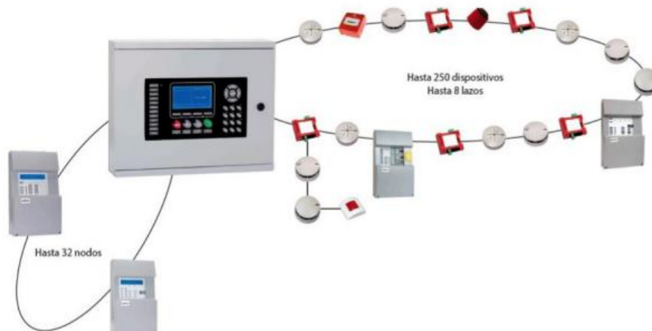
Imagen 6: Panel de detección de incendios y sus componentes
