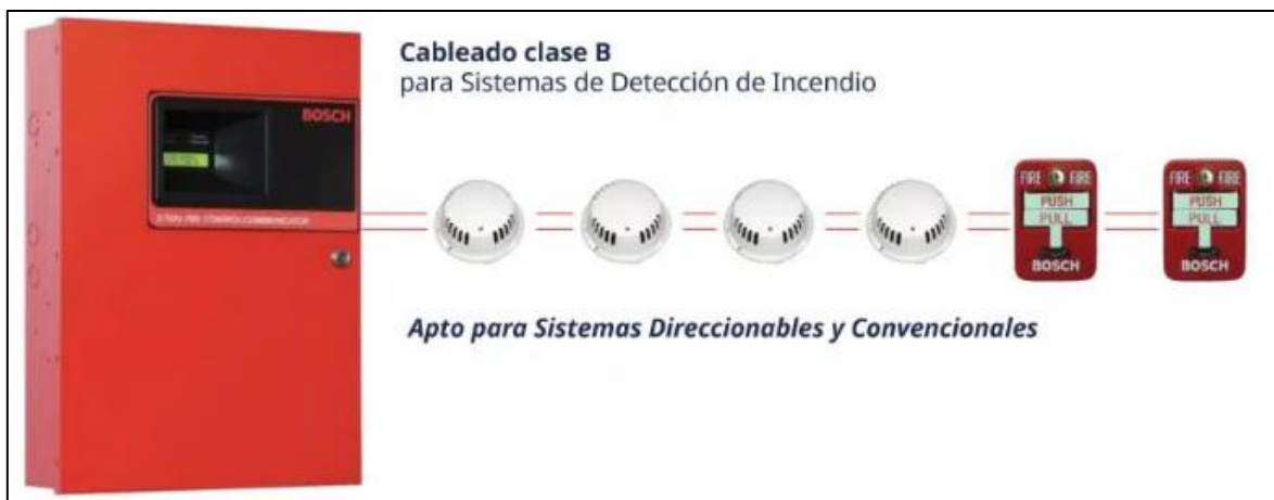
Imagen 5: Cableado clase B
