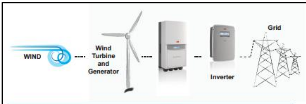
Figura 27: Sistema de conversión de energía
