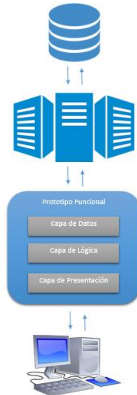
Figura 22. Arquitectura del sistema
