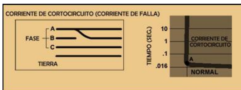
Figura 2. Curva de tiempo de corriente de corto circuito. Fuente: EATON Módulos de Aprendizaje #5.
