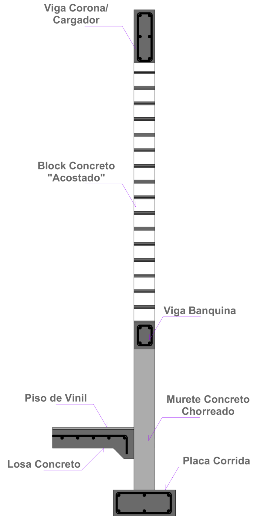
Ilustración 63, Detalle Constructivo Muros Externos, Propiedad Personal, Tomado 2023
