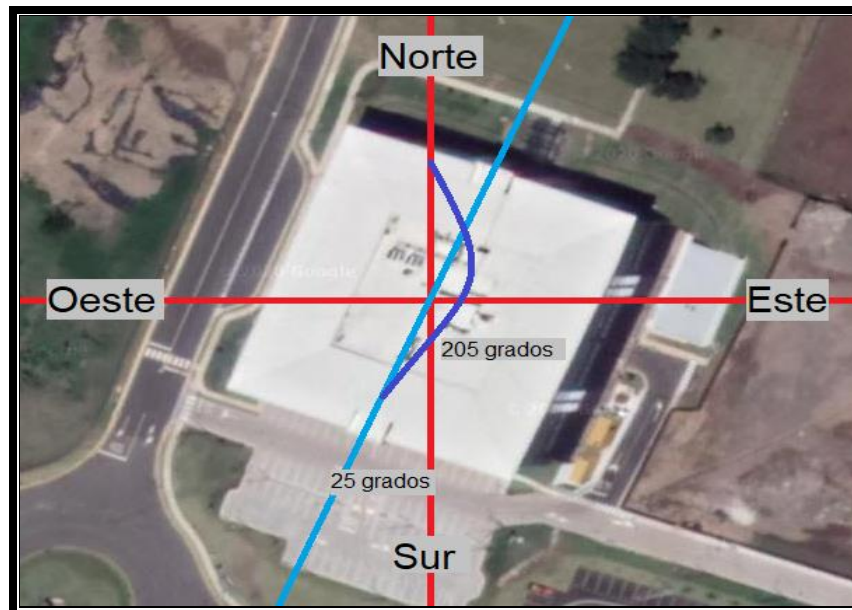
Figura 31. Ángulo azimutal del inmueble. Fuente: Elaboración propia.
