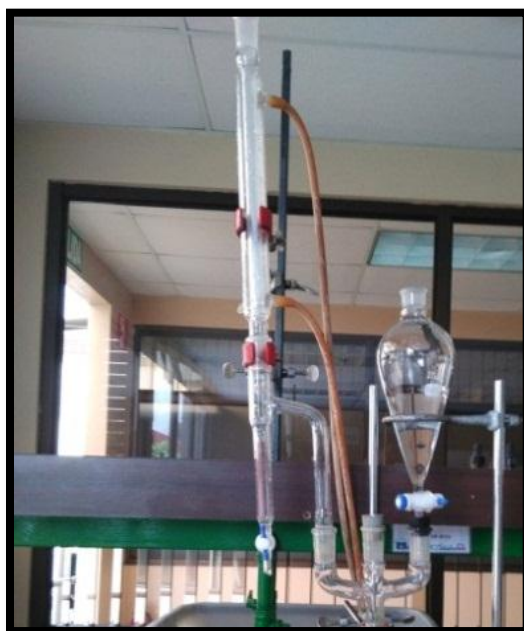
Figura 15. Equipo Utilizado para la Hidrodestilación Adaptado con un Aparato Dean-Stark
