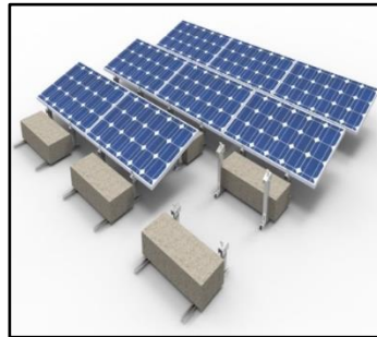
Ilustración 2.21. Balastado al Techo
