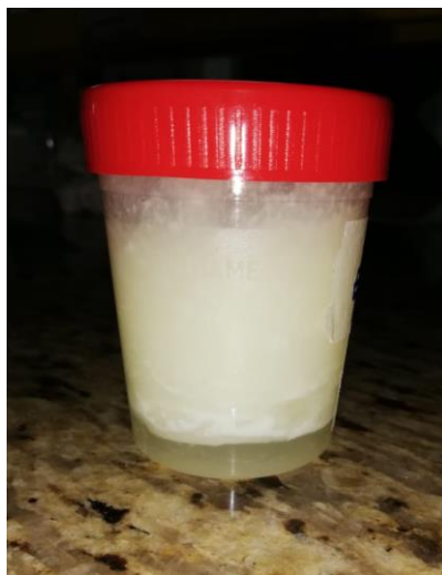
Figura 20. Separación de fases de emulsión w/o causada por el insuficiente efecto emulsificante de lanolina.
