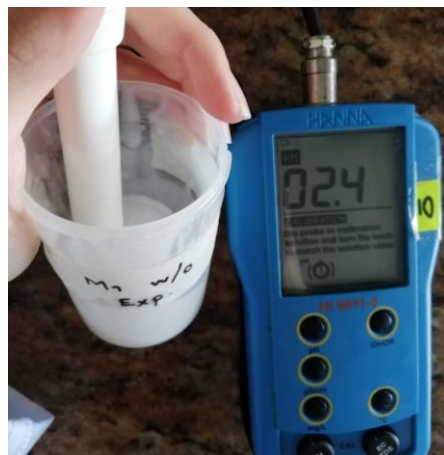
Figura 44. Medición de pH de las muestras de las emulsiones posterior a pruebas de estrés.
