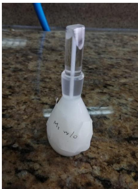
Figura 38. Medición de densidad de las emulsiones.
