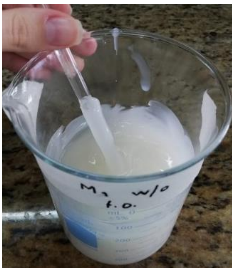
Figura 28. Agitación de emulsión w/o hasta enfriar.
