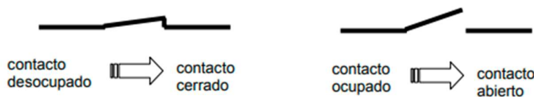
Figura 14 Funcionamiento de un contacto cerrado
