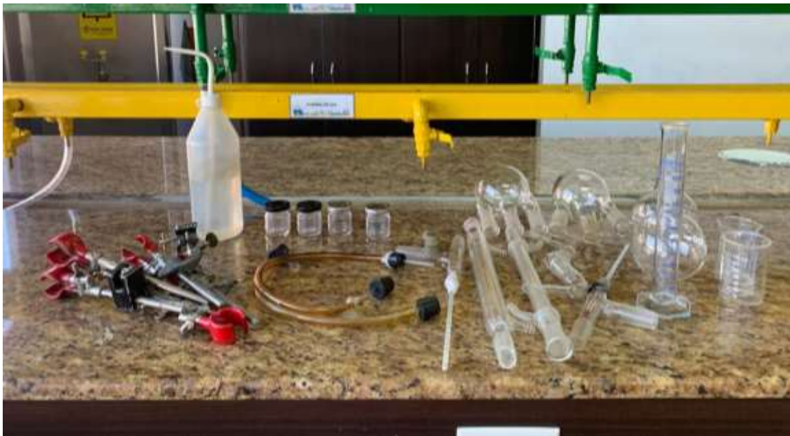
Figura 31. Equipo a utilizar para el arrastre por vapor
