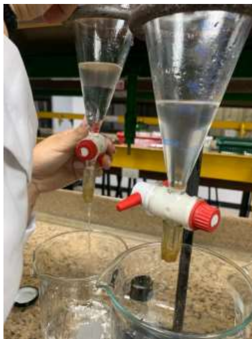
Figura 51. Separación de la fase oleosa y acuosa de las muestras de romero.
