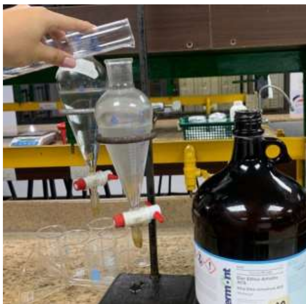
Figura 50. Procesos de lavado de las muestras con éter etílico.
