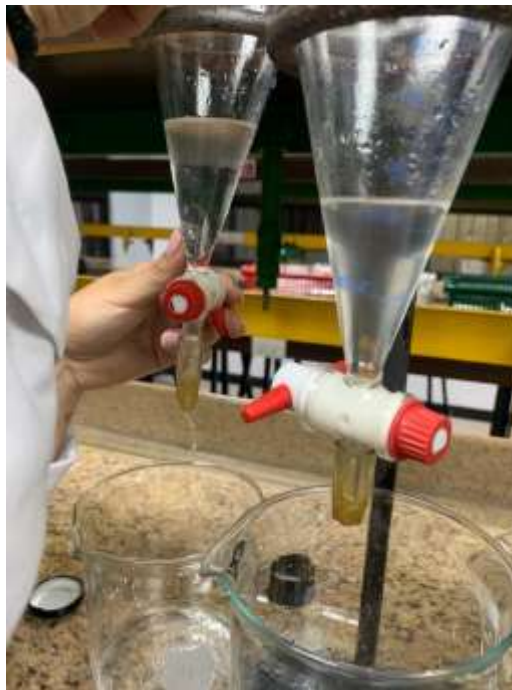
Figura 34. Eliminación de la fase acuosa (éter) mediante separación de fases.
