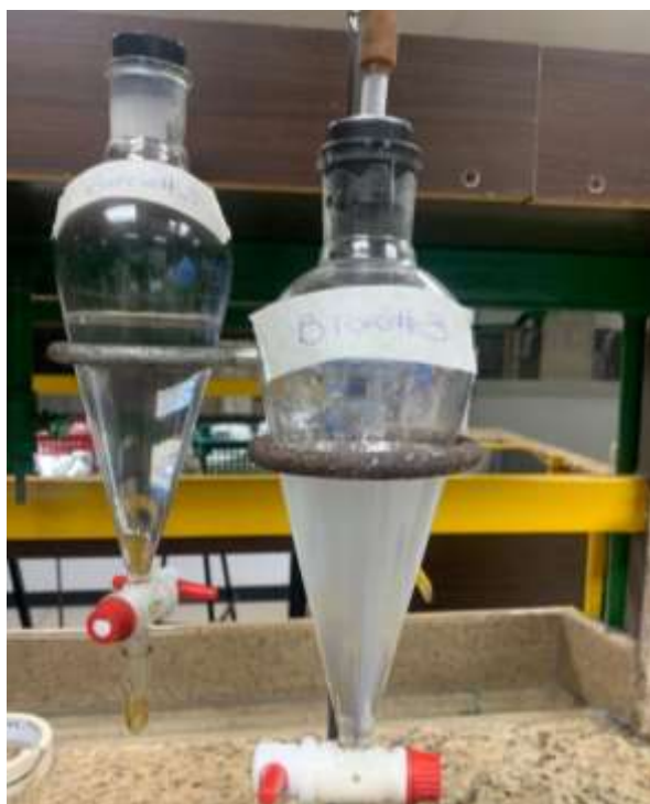
Figura 49. Muestras de ambos extractos finales del proceso de arrastre por vapor, en los embudos separadores.
