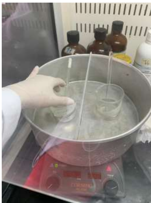
Figura 38. Proceso de evaporación del éter en la capilla, para ambas muestras.
