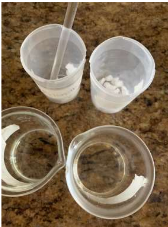
Figura 37. Muestras después de la decantación del sulfato.
