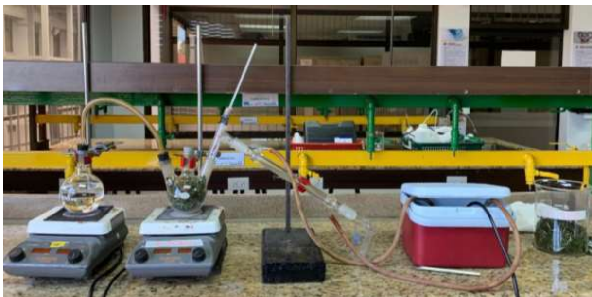
Figura 46. Procesos de arrastre por vapor de Bajos del Toro al inicio.
