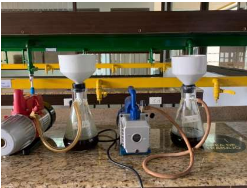
Figura 59. Filtración al vacío de ambas muestras de maceración.
