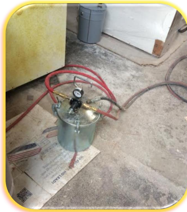
Figura 33: Tanque de pegamento en spray
