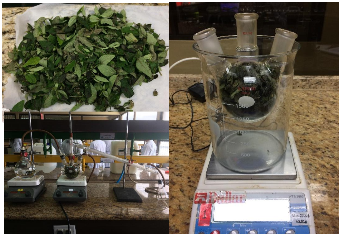
Figura 41. Método de Extracción del Aceite Esencial de Origanum vulgare por Arrastre con Vapor
