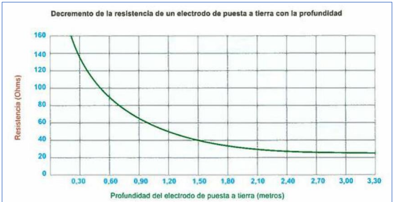
Figura 5 Gráfica de resistencia vs. profundidad del electrodo de puesta a tierra.
